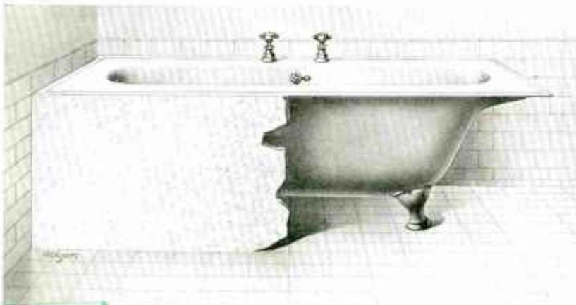
Fig. 1367. — Baignoire PISCINE 1<sup>m</sup>03 x 0<sup>m</sup>84, bords de 13 cm, montée avec robinets et les jets à gros capuchon dépassent sur la gorge, alimentation par mascaron, plaque en cuivre nickelé. Fig. 2205.
