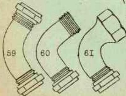
Fig.60 COUDE p<sup>r</sup> Tube cuivre et mâle pas fer
