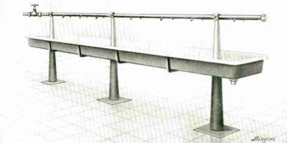
Fig. 9010: hauteur du sol au bord supérieur 91 cm., largeur du Lavabo 72 cm., creux 20 cm., diamètre prévu pour tuyau de distribution 60 mm.
